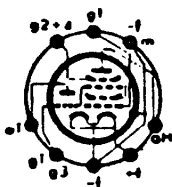
Bild 336. Sockelschaltung der DCH 11.
